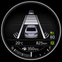
einem Bereich von bis zu 100 Metern und leitet bei einer möglichen Kollision eine automatische Notbremsung ein.
