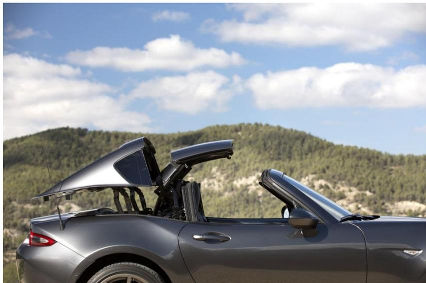
Das Dach öffnet und schließt bei einem Tempo von bis zu 10 km/h; der Fortschritt lässt sich auf einem neuen 4,6-Zoll-Farbdisplay links im Kombiinstrument beobachten. Das Display weist den Fahrer auch darauf hin, wenn das Dach gerade nicht bedient werden kann - etwa bei geöffnetem Kofferraum oder beim Rückwärtsfahren - und zeigt darüber hinaus Tankfüllstand, Motortemperatur, Kraftstoffverbrauch und Kompass-Informationen an.
