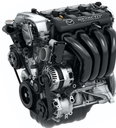
Im Vergleich zu Mazda Modellen mit Frontantrieb ist der Motor im MX-5 kompakter und drei Kilogramm leichter. Er verfügt über leichtere und kompaktere Einlass- und Abgassysteme, ein zehn Prozent leichteres Schwungrad sowie einen modifizierten 4-2-1 Abgaskrümmen, der auf das Hinterradantriebslayout sowie auf eine optimale Drehmomentkurve ausgelegt wurde. Selbst der Kühler
