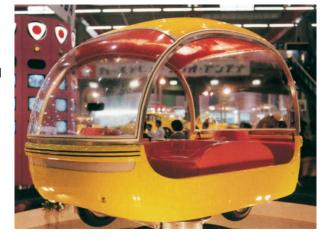
net, also zwei in der Mitte und jeweils eins vorne und hinten. Angetrieben werden die mittleren Räder. Die Lenkung erfolgt über einen im Cockpit zentral angebrachten Joystick, der die mittleren Räder je nach Lenkrichtung unterschiedlich schnell beschleunigt. Der Effekt ist vergleichbar mit einem Ruderer: Rudert er nur rechts, gleitet sein Boot nach links – und umgekehrt. So hat der EX 005 den kleinsten denkbaren Wendekreis, da er sich auf der Stelle drehen kann.
