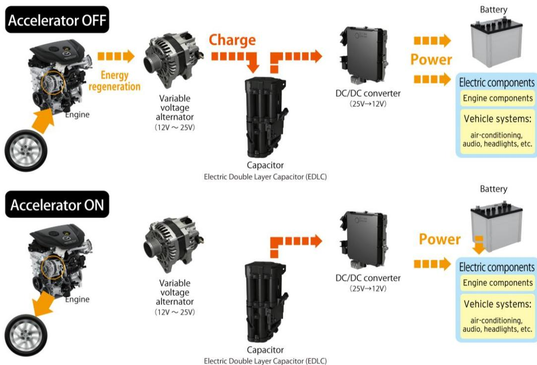
Durch den Einsatz von i-ELOOP wird der Verbrennungsmotor von der Aufgabe entlastet, Strom für die elektrischen Verbraucher im Fahrzeug zu erzeugen und dabei zusätzlichen Kraftstoff zu verbrennen. Im Ergebnis lässt sich der Verbrauch im Stop-and-Go-Verkehr um bis zu zehn Prozent verringern. i-ELOOP arbeitet außerdem mit dem Start-Stop-System i-stop zusammen.
