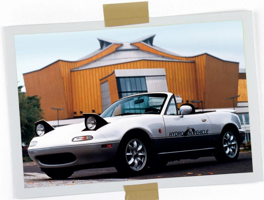
Die internationale Motorpresse äußerte sich nach ausgiebigen Testfahrten sogar begeistert über die flotte - und vor allem absolut zuverlässige und saubere - Fortbewegung mit der neuen Technik in mir als MX-5 HEV. Kreiskolbenmotoren sollen im Gegensatz zu herkömmlichen Hubkolbenmotoren besonders gut für den Betrieb mit Wasserstoff geeignet sein, so ist etwa ihr Zündverhalten gut zu regulieren.
