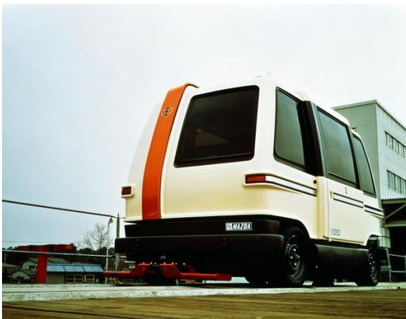
Das kastenförmige Karosseriekonzept der CVS Fahrzeuge nimmt bereits einige Ideen der erst über zehn Jahre später in Serie gehenden Großraumlimousinen vorweg. So bieten weit öffnende Schiebetüren bequemen Zugang ins großzügig dimensionierte Interieur, wo bequeme Einzelsitze mit außergewöhnlich viel Bein- und Kopffreiheit auch großgewachsenen Passagieren First-Class-Reisekomfort garantieren.
